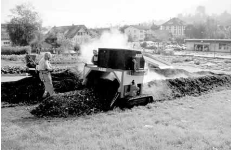
Maschineller Umsetzservice in Köniz in Absprache mit Kompostgruppen erspart schwere körperliche Arbeit auf grossen Plätzen.
