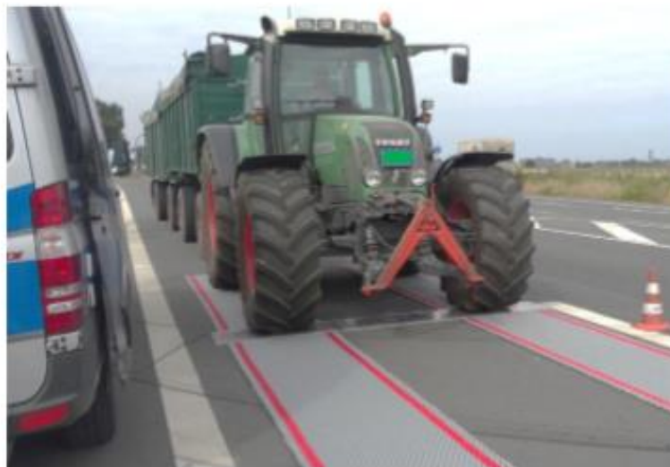
Min. 22% des Betriebsgewichtes des Zuges auf dem Traktor
