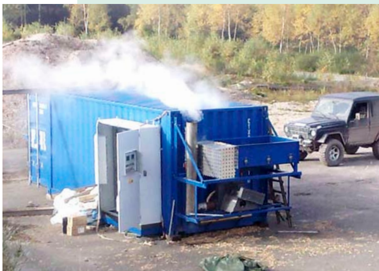
Eine Pyrolyse-Anlage stellt aus Grüngut Biokohle her. Une installation de pyrolyse produit du «charbon bio» à partir de déchets verts.
