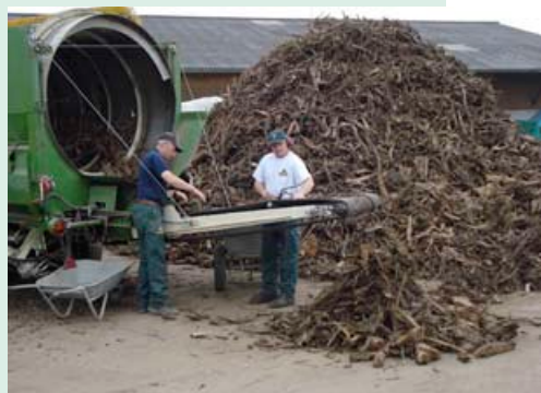
Nach dem Shreddern der Wurzelstöcke müssen Steine von Hand aussortiert werden. Après le broyage des souches, les pierres doivent être triées à la main.
