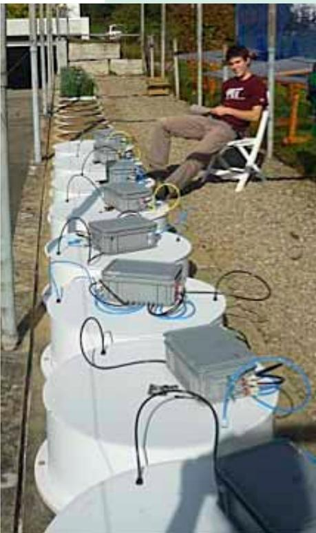
Treibhausgas-Messung auf der Lysimeteranlage am Agroscope Reckenholz.
