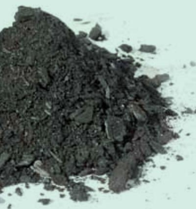
**Biochar-Pyramide: Pyreg-Kohle aus der Maschine.**
