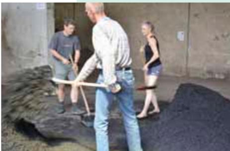
Die repräsentative Probenahme ist eine Voraussetzung für analytisch sinnvolle Daten. Hier die Autoren bei der Homogenisierung einer Pflanzenkohlenprobe.
